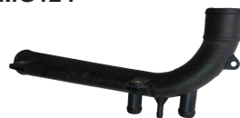
TUBO DE CIRCULAÇÃO D'ÁGUA DO MOTOR N° Original: 90530728
